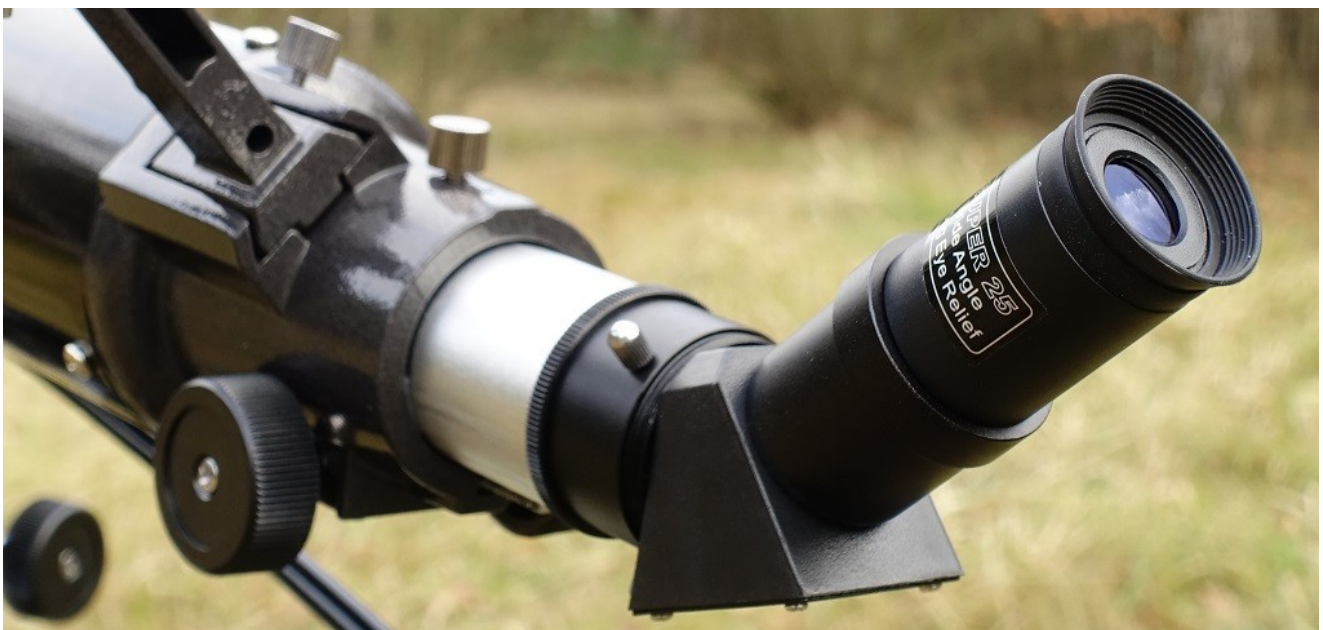
Do teleskopu dołączany jest pryzmat Amiciego o kącie odgięcia 45 stopni. Oferuje on obraz prosty, niezbędny w obserwacjach ziemskich.
